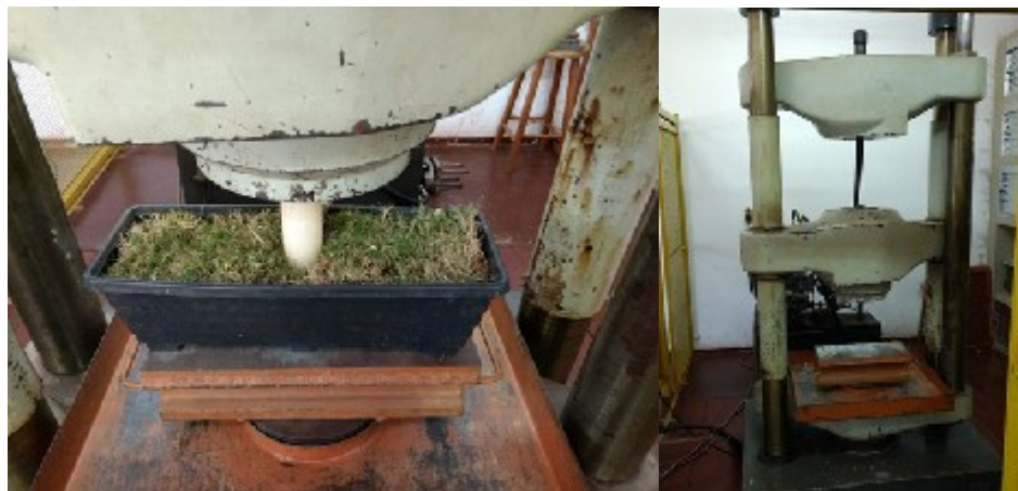
Figura 1 – Compactação artificial aplicada no ponto central do contêiner. Ilha Solteira – SP, 2018.
