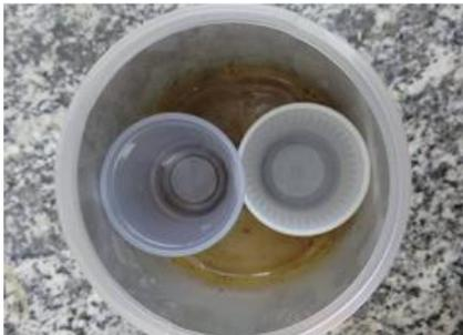
**Figura 3** - Frasco de plástico com 100 g de solo úmido, com copo plástico contendo 15,0 mL de NaOH 0,5 N padronizado para capturar o CO<sub>2</sub> produzido e outro copo plástico contendo 10,0 mL de água destilada para manter a umidade do ambiente
